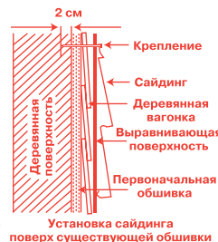
Установка сайдинга поверх существующей обшивки
